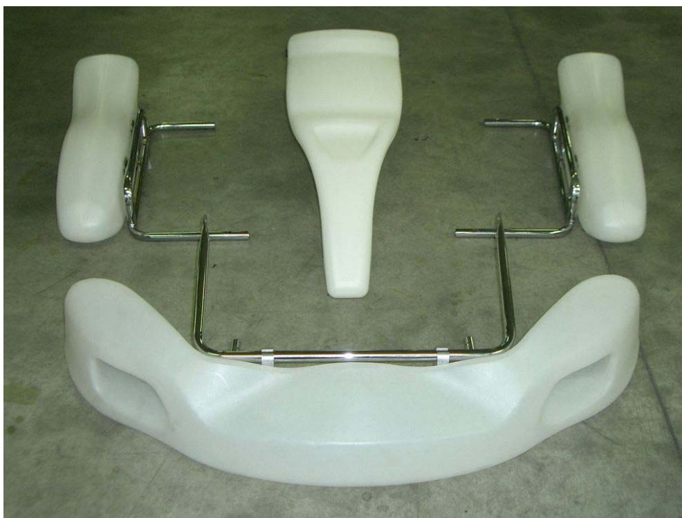
PHOTO VUE DE DESSUS DES ÉLÉMENTS DE CARROSSERIE AVEC LEURS SUPPORTS PHOTO FROM ABOVE OF BODYWORK ELEMENTS WITH THEIR SUPPORTS
